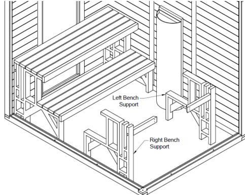
PLACE A BOTTOM BENCH ONTO THE SUPPORTS. USING A LEVEL, ADJUST THE LEVLNING FEET ON THE SUPPORTS UNTIL THE BENCH IS LEVEL FROM LEFT TO RIGHT AND FRONT TO BACK.
