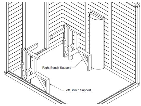
PLACE A BOTTOM BENCH ONTO THE SUPPORTS. USING A LEVEL, ADJUST THE LEVLNING FEET ON THE SUPPORTS UNTIL THE BENCH IS LEVEL FROM LEFT TO RIGHT AND FRONT TO BACK.
